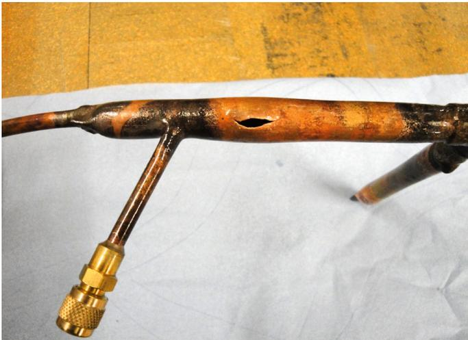
Berstversuch an einem gelöteten Kupferrohr
