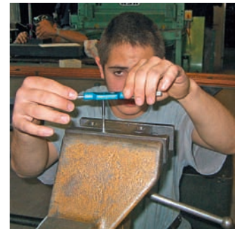
Präzisionsarbeit beim Gewindebohren
