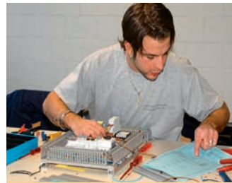
Verdrahtung im Schaltta-bleau (KMK 4)
